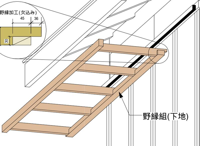
組上げた野縁の欠込み部分をイーフスベントツの上に仮置きしてから90mmの釘で固定します。
